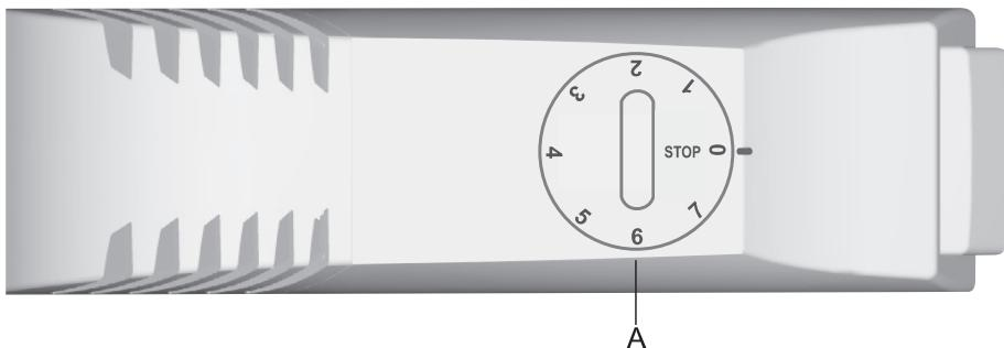
A Otočný regulátor nastavenia teploty a zapnutia/vypnutia
